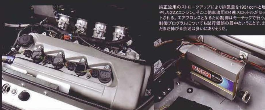
純正流用のストロークアップにより排気量を1931ccへと増やした2ZZエンジン。そこに他車流用の4連スロットルがセッティングされる。エアプロレスとなるため制御はモーテックで行う。制御プログラムについても試行錯誤の最中ということで、まだまだ伸びる余地が多いにありそうだ。
